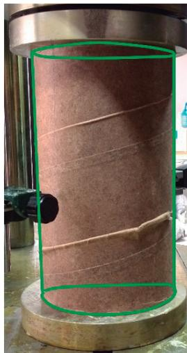
**Figura 7.** Ensayo de compresión axial
