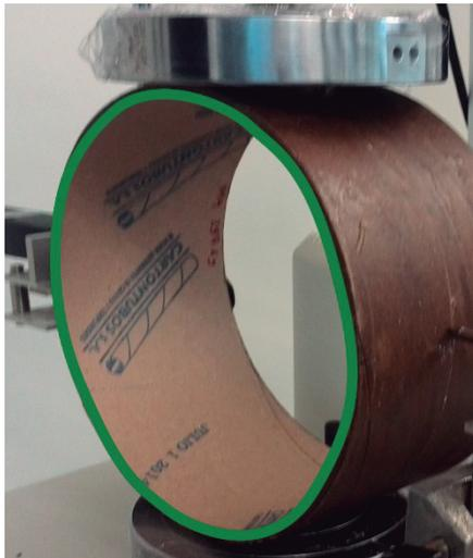
**Figura 1.** Ensayo de compresión diametral
